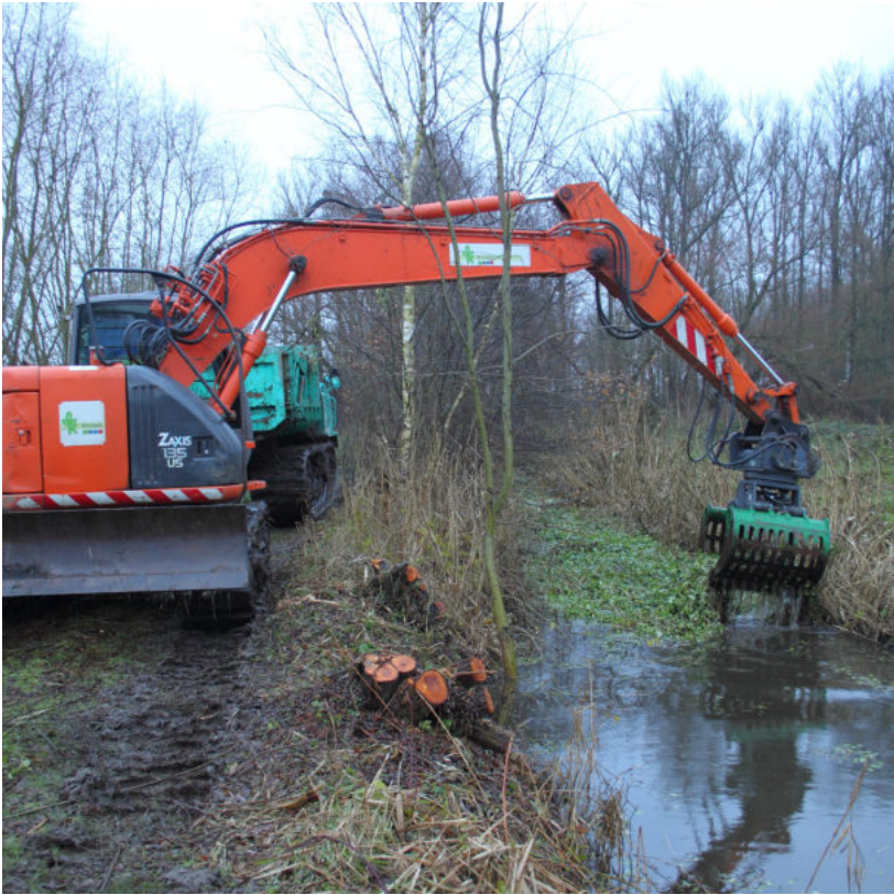
Fig 23. Graafmachines die op de oever blijven staan, worden gebruikt voor het verwijderen van grote waternavel uit een stelsel van kleine waterwegen. Foto: Jérémie Guyon.
