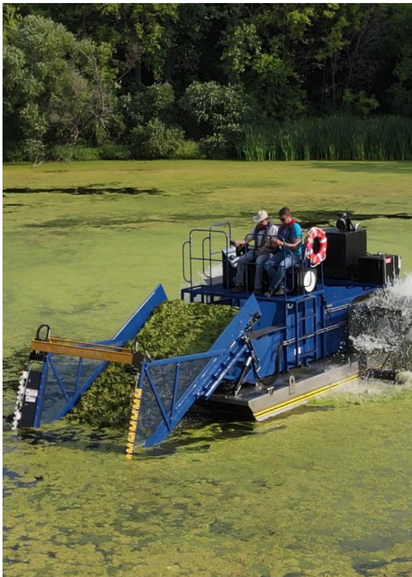
Fig 11. Mechanische verwijdering door middel van drijvende machines wordt meestal toegepast in grotere waterpartijen. Foto: Aquarius Systems.
